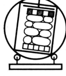
④ 片寄せし、荷くずれを防止してから、押板を作動させる
